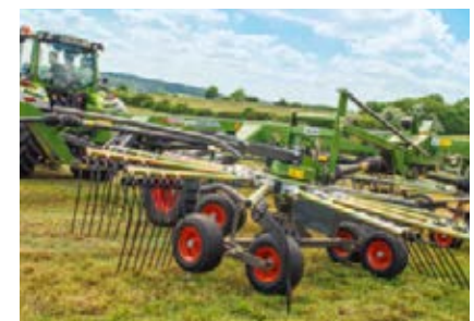
Lors de la descente en bout de champ, ce sont les roues arrière qui entrent en premier en contact avec le sol, puis celles avant. Lors du relevage, les rotors sont soulevés à l'avant en premier. Cet effet Jet protège le tapis végétal.
