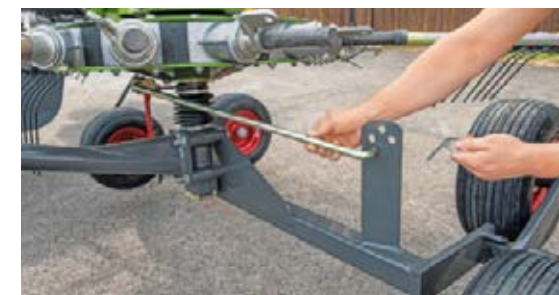
Que le fourrage soit long et lourd ou court et léger : le chemin de comes peut être ajusté facilement en fonction des conditions de récolte.
