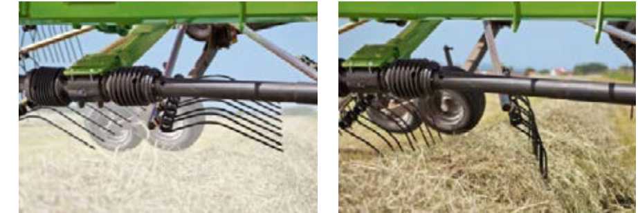
Sur la gauche, vous pouvez voir les dents soulevées par le CamControl. L'andain est protégé par l'impressionnante garde au sol. L'image sur la droite montre un système conventionnel, laissant un andain endommagé.
